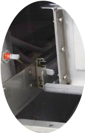
Fermez le verrou du mécanisme d'extraction sur la droite.
