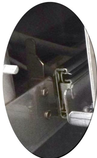
Ouvrez le verrou du mécanisme d'extraction sur la droite.
