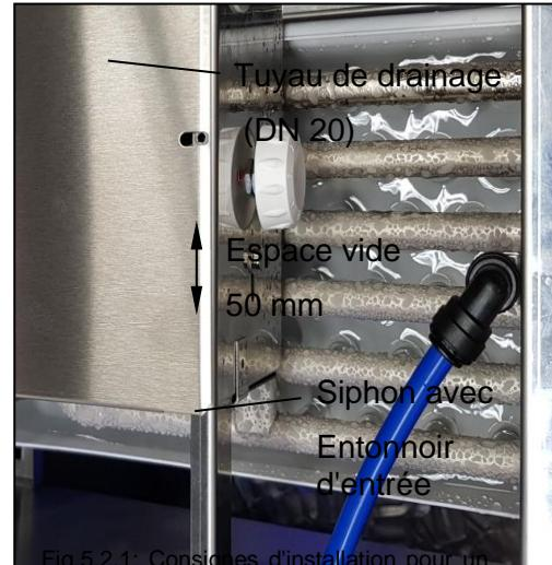
Fig.5.2.1: Consignes d'installation pour un drainage hygiénique de l'eau résiduelle
